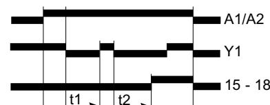
Nach dem Anlegen der Steuerspannung verbleibt der Kontakt solange in der Ausgangsposition, bis die Summe der Steuerspannungsunterbrechungen die eingestellte Verzögerungszeit ergibt. Danach wechselt der Kontakt in die Wirkstellung (Kontakt 15/18). Der Kontakt verbleibt bis zum Abschalten der Versorgungsspannung in seiner Wirkstellung.
