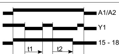
Mit dem Anlegen der Steuerspannung wechselt der Kontakt von der Ausgangsstellung (Kontakt 15/16) in die Wirkstellung (Kontakt 15/18). Erreicht die Summe der Steuerspannungsunterbrechungen die eingestellte Wischzeit, wechselt der Kontakt zurück in die Ausgangsstellung. Der Kontakt kann erst nach einer Unterbrechung der Versorgungsspannung in die Wirkstellung wechseln.
